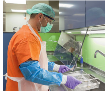
Frontale Schutzscheibe stufenlos einstellbar, im Wandschrank integriert
